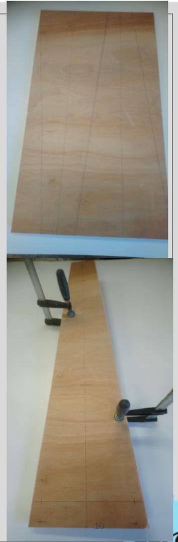
5 - Tracer les trous suivant plan joint , puis percer les 2 pièces serrées ensemble.
