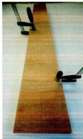
5- tracer les trous suivant plan joint , puis percer les 2 pièces serrées
